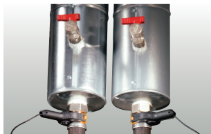
Sonda a pinza per tubazioni con diametro da 6 mm a35 mm, NTC
